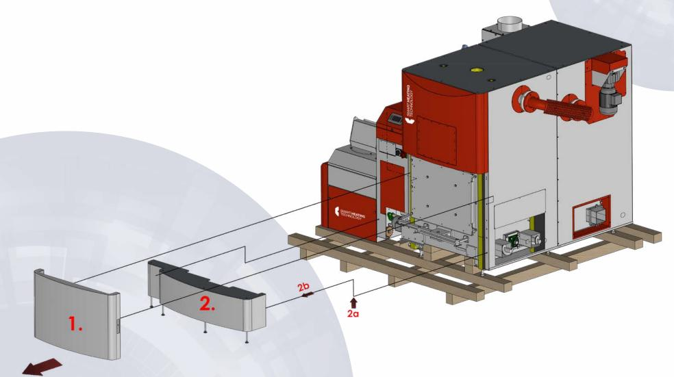
6. Retire las partes inferiores delanteras del revestimiento de la caldera.
