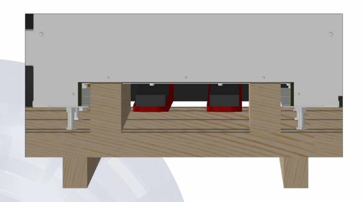
8. Dirija las uñas de su carretilla elevadora por debajo de la cámara de combustión/sección del intercambiador, ¡entre las vigas de madera del apoyo!
