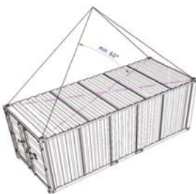
Figure 1 – Angle de levage pour les coins ISO supérieurs
