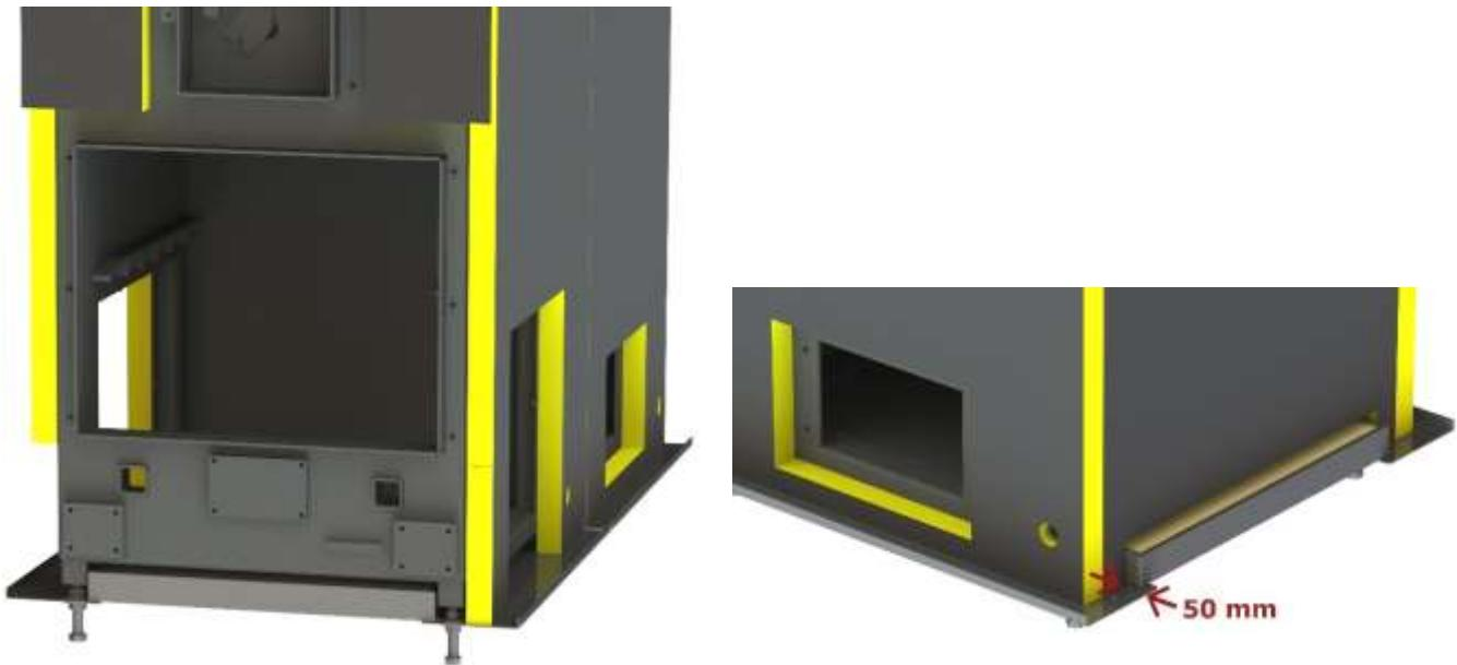
8. Do spalovací komory vsuneme a přišroubujeme podavač paliva. Strana u vstupních ventilátorů se šroubuje přímo do spalovací komory, na straně u výstupu popelových šneků musíme použít pomocnou přírubu.
