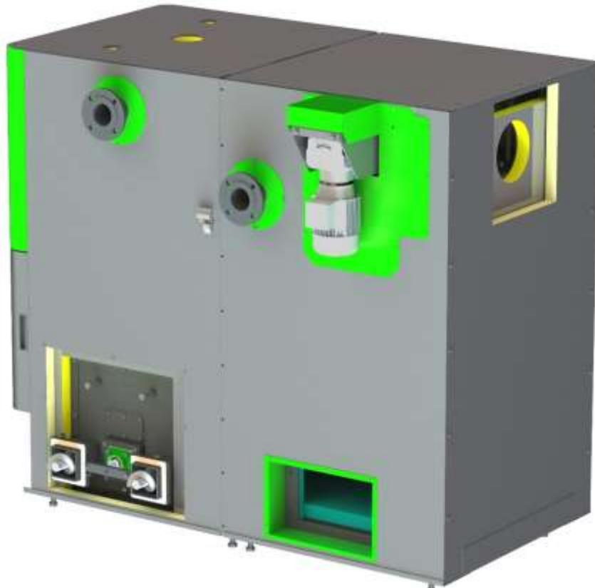
23. Přišroubujeme komínovou nádstavbu. Komínová nádstavba je osazena jímkou pro čidlo teploty spalin a lambda sondou. Mezi tepelným výměníkem a komínovou nádstavbou musí být vlepeno teflonové těsnění. Komínová nástavba lze intalovat ze zadu, zleva i z prava. Pro tuto variabilní montáž jsou výrobcem připraveny montážní otvory a krycí plechy opláštění kotle.
