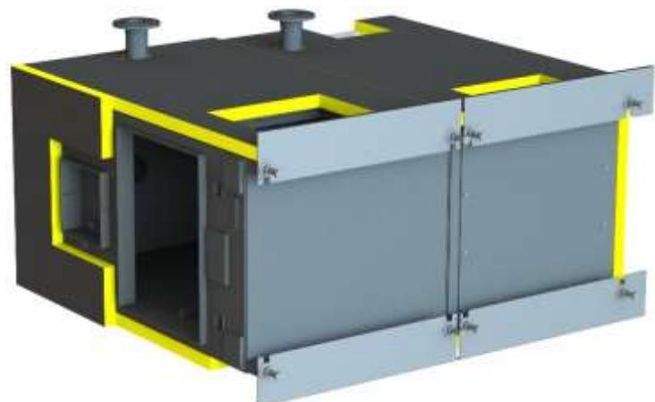
7. Pod kotel zasuneme plechy s izolací. Na zadní straně výměníku musíme nechat 50 mm místa pro zadní díl vnějšího opláštění.
