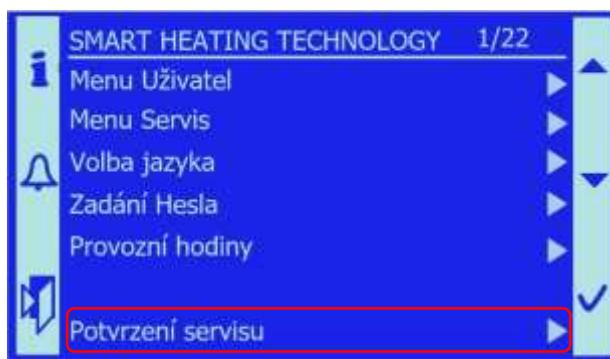
Obsluha zařízení je povinna po tomto hlášení provést předepsané kontrolní úkony a provést údržbu zařízení. Potvrzení servisních úkonů provede obsluha v menu Potvrzení servisu.
