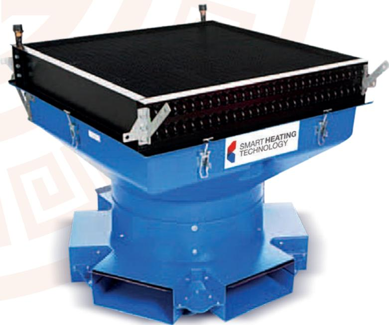
Smart360°热风系统包含高效热能交换机、轴流式风扇和一个拥有独特设计的流通设备。由外部锅炉供应的热水会流经热能交换机，风扇通过热能交换机吸入建筑物的空气并通过6个送风口推出热风。
