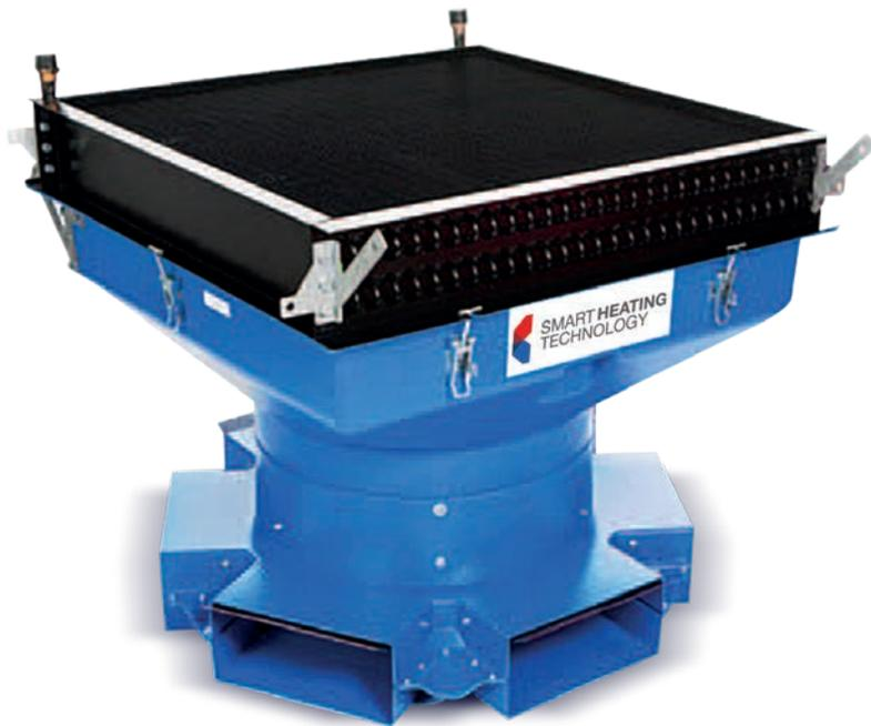
L'unité Smart Air 360 ° se compose d'un échangeur de chaleur à haut rendement, d'un ventilateur axial et d'un dispositif de distribution d'air unique. L'eau chaude est fournie par la chaudière externe et traverse l'échangeur de chaleur. Le ventilateur aspire l'air intérieur de l'immeuble à travers l'échangeur de chaleur et le pousse. L'air chaud au travers des 6 sorties d'air.
