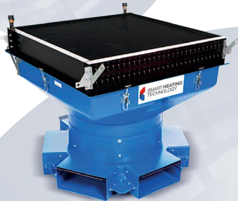
Una unidad de distribución de aire única los Calentadores de Aire Simpáticos 360° unidad consisten en el alto transformador de calor de eficacia, el abanico axial y un dispositivo de distribución único diseñado. El agua caliente es suministrada de una caldera externa y pasa el transformador de calor. El abanico aspira el aire de dentro del edificio por el transformador de calor y empuja el aire caliente igualmente por las 6 salidas de aire.
